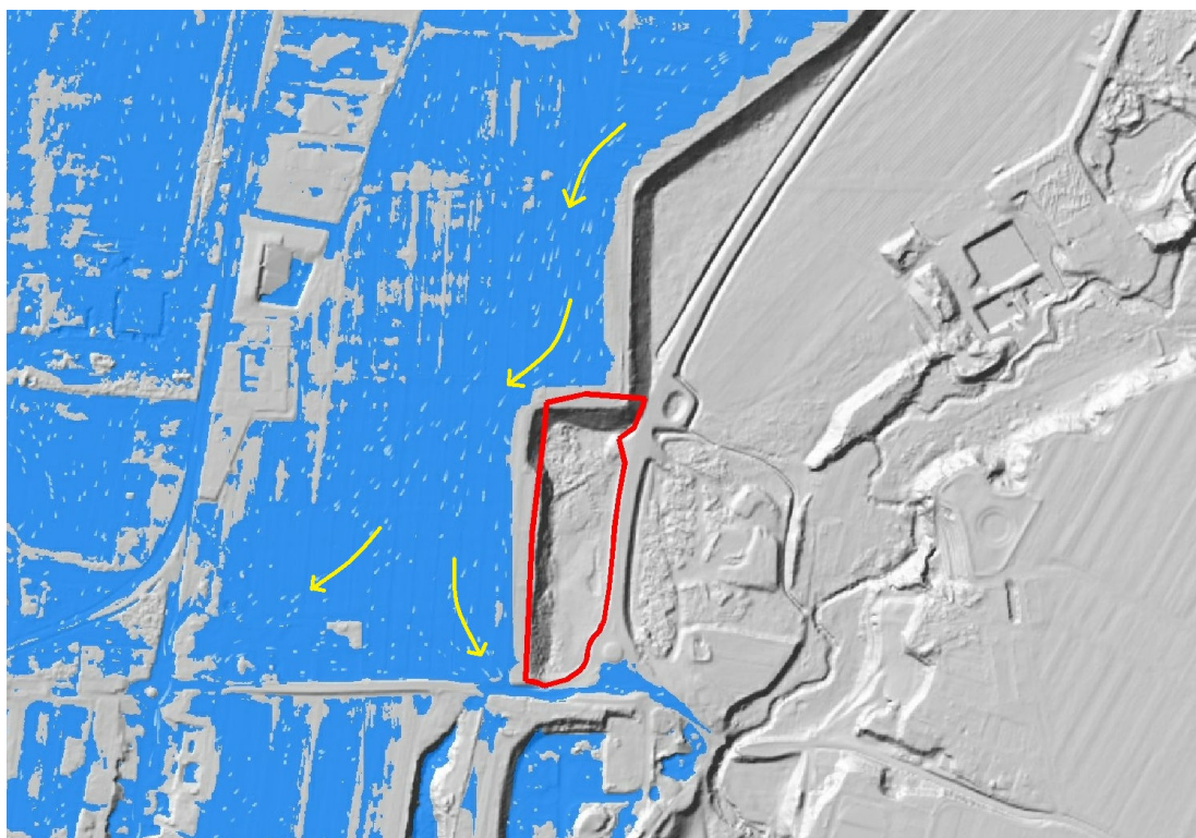
Slika 3: Smeri odvodnje zalednih voda (Vir: Hidroinštitut d.o.o. Ljubljana)
